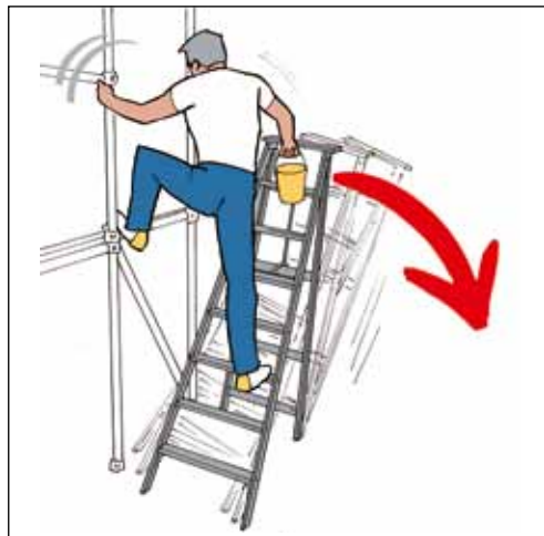
Abbildung 3: Kippgefahr durch seitlichen Druck (beim Aufstieg)
