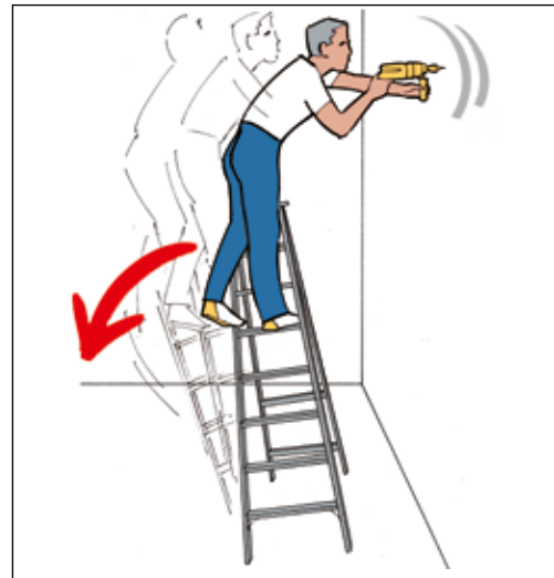
Abbildung 4: Kippgefahr durch seitlichen Druck (beim Arbeiten)
