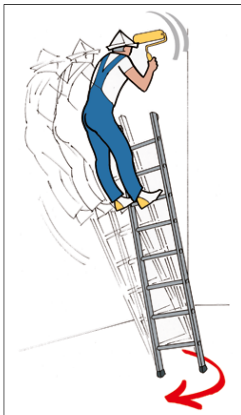
Abbildung 10: Seitliches Hinauslehnen vergrößert die Rutsch- und Kippgefahr
