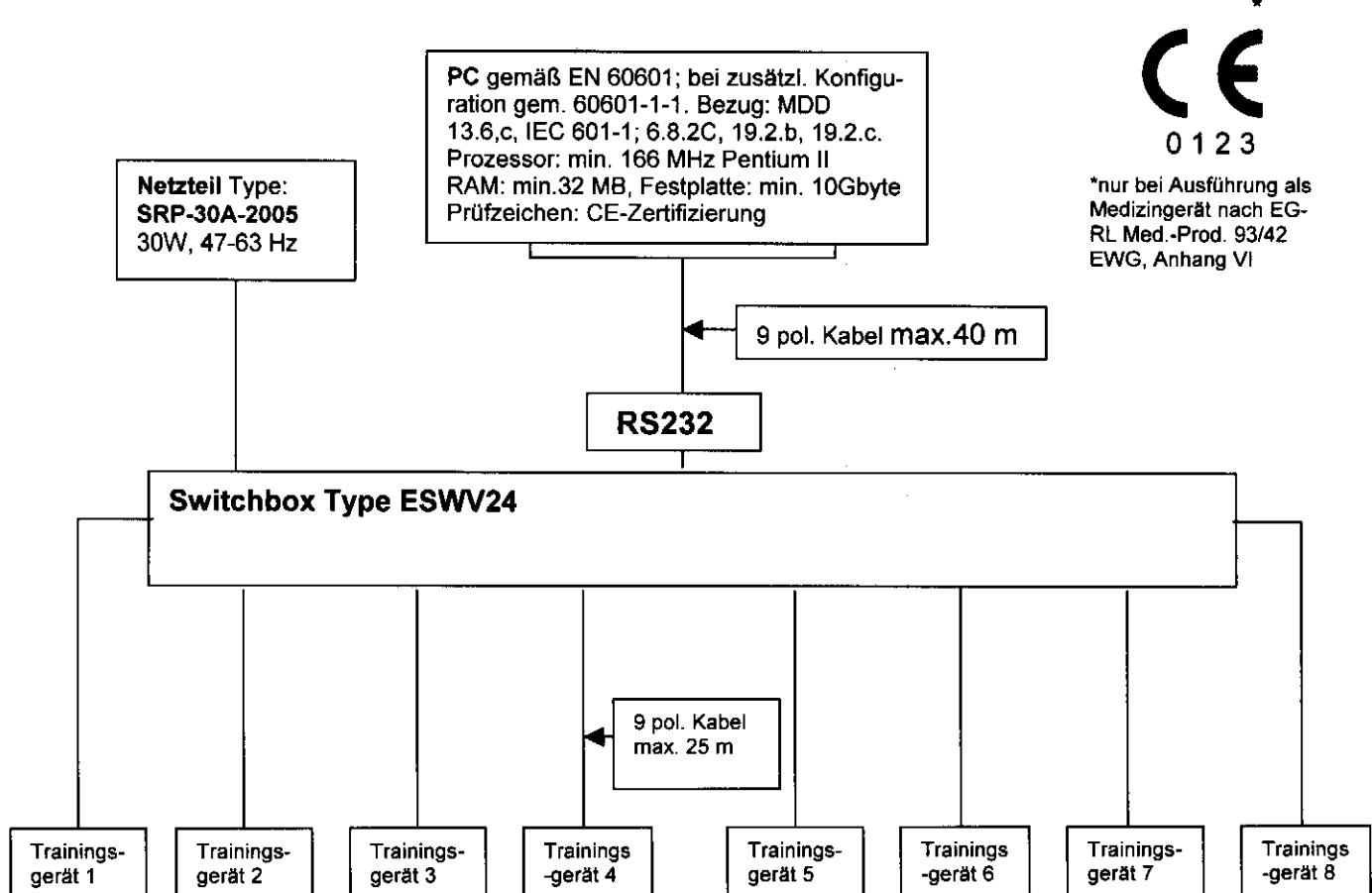
Im Übrigen sind die Leitlinien und Herstellererklärungen (Anlage) zu Elektromagnetische Aussendung, Störfestigkeit und die empfohlenen Schutzabstände zwischen tragbaren und mobilen HF-Telekommunikationsgeräten und dem ESW8V24 zu beachten.
